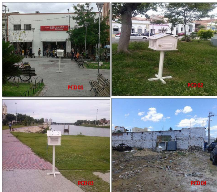
Figura 15 - Mini abrigos meteorológicos instalados nos PCD's
