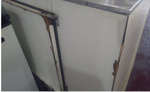
Figura 4 - Balcão térmico com desgastes
